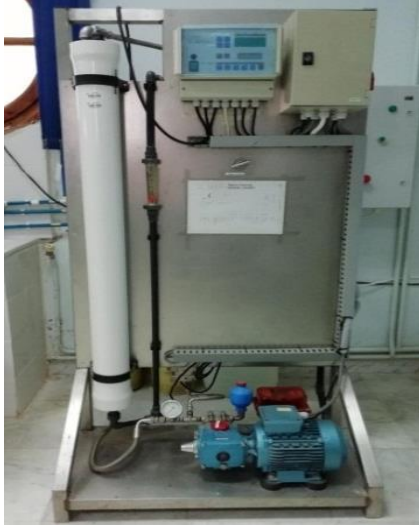
الصورة 2 محطة مصغرة لتحلية مياه البحر بالطاقة الشمسية لوحدة تنمية الأجهزة الشمسية/ الجزائر.
